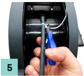
5 Abschneiden des überschüssigen Kabelbinders
