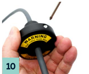
9 Anbringen des Kabeleinzugstoppers am Anschlusskabel Montageposition ca. 1-1,5 m vom Handbediengerät entfernt
