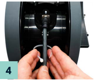
3 Freie Anpassung der Zugentlastung
