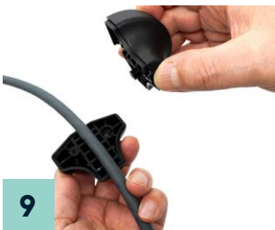
9 Anbringen des Kabeleinzugstoppers am Anschlusskabel Montageposition ca. 1-1,5 m vom Handbediengerät entfernt
